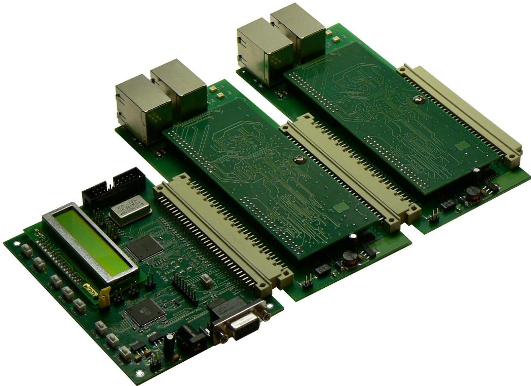
Комплект позволяет производить подключение от 2 до 5 модулей E2S-3 через TDM, выполнять их настройку, а также производить проверку работоспособности различных конфигураций сети, построенной с использованием модулей E2S-3.
